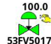
Пиктограмма регулирующего клапана на мнемосхеме
